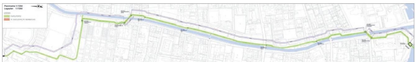
Le condutture per il trasporto dell'acqua (in verde) seguono il corso del fiume Cassarate per 2.8 km attraversandone il letto due volte.
